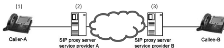
圖 4 網路電話 SIP 連線示意圖
